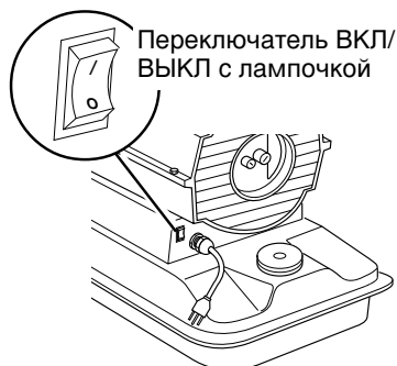
Рис. 5. Кнопка повторного зажигания для нагревателей мощностью 10, 18,5 и 20 кВт
