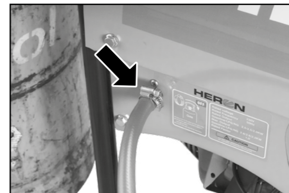
Spôsob pripojenia plynovej hadice k elektrocentrále Obr. 14
