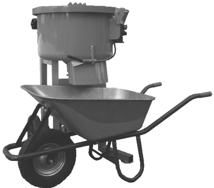
**D** Rührwerkkopf zum Reinigen abnehmen
